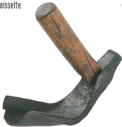
Petit outil du tonnelier constitué d'un marteau d'un côté et d'une petite hache recourbée de l'autre côté 10 .
